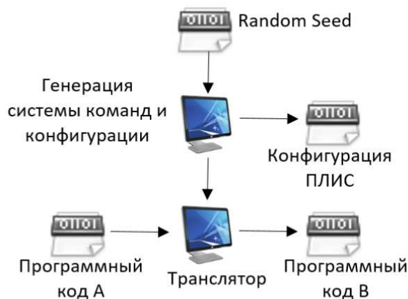
Рис. 4. Этап 0: генерация случайной системы команд и конфигурации ПЛИС
